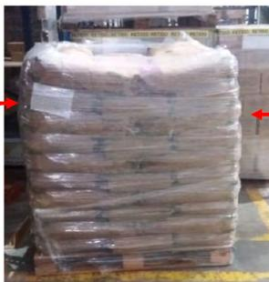
**Dentro do padrão:** Neste caso a carga não ultrapassou os 10mm sobre a área do Pallet, conforme seta em vermelho, indicando o problema.
